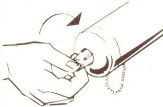
3.3. Pistolendeckel über Spritzdüse führen und auf Zylinder verriegeln.
