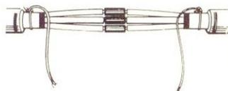
1. Absetzen des Kabels so kurz wie möglich. Kabelmantel an beiden Enden etwa auf die Länge eines Kabeldurchmessers absetzen. Leiterisolation nur so weit entfernen, wie zum Anbringen der Verbinder notwendig ist. Platzsparende Hülsen oder Klemmen verwenden.
