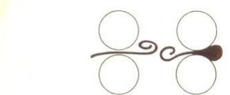
2. Zwischenraum zwischen Hauptkabel und Abzweig mit Scotchfil Elektro-Isolier- plast ausfüllen und fest andrücken. Dichtungsmanschetten aus Scotchfil
