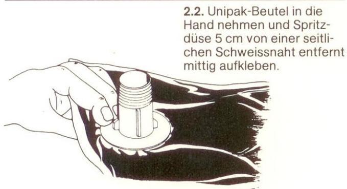
2.2. Unipak-Beutel in die Hand nehmen und Spritzdüse 5 cm von einer seitlichen Schweissnaht entfernt mittig aufkleben.
